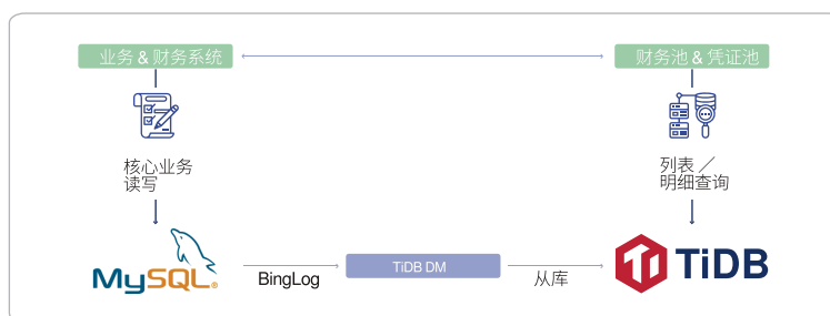
图：多点业财一体化 TiDB 部署架构图 1
